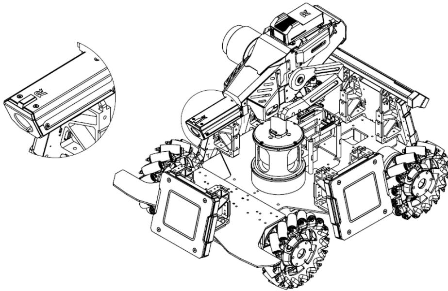
图 3-32 测速模块安装示意图
