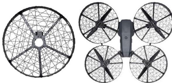
S52 全封闭桨叶保护罩受 2 m 距离外速度为 12 m/s 的 42 mm 弹丸射击后，保护罩任意部分不可产生接触桨叶的形变，影响桨叶的正常转动，且该 42 mm 弹丸不可穿过保护罩网孔，建议保护罩最大网孔面积不大于  $9 \text{ cm}^2$ 。
