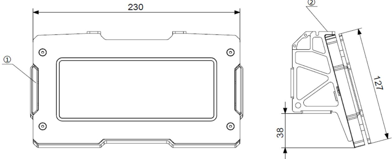
[1] 侧灯 [2] 顶部用 M4 螺钉固定
