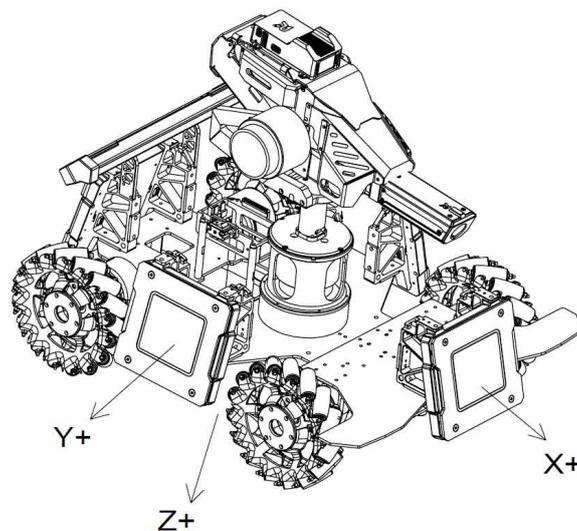
图 3-17 机器人坐标系示意图
