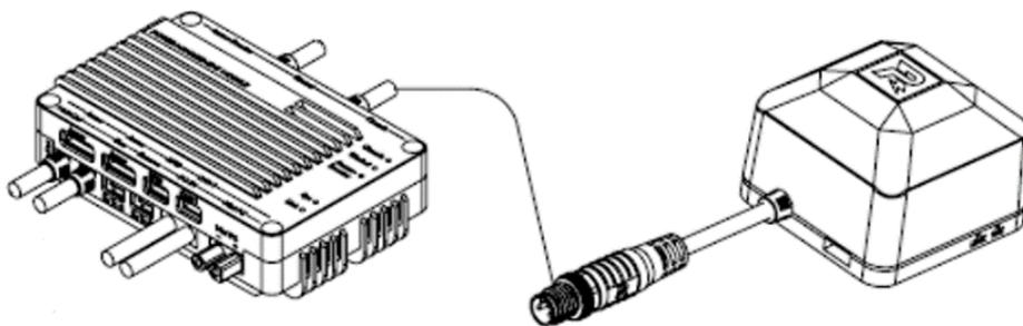
图 3-47 定位模块连线示意图
