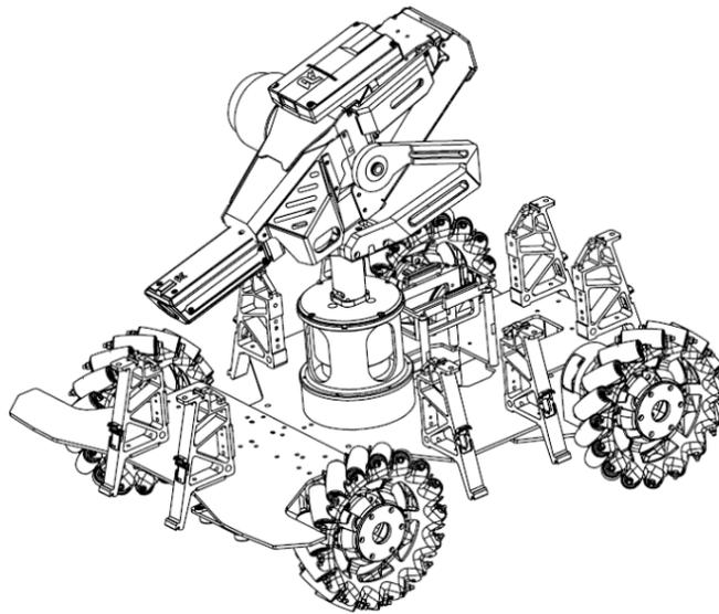
图 3-22 装甲支撑架安装示意图
