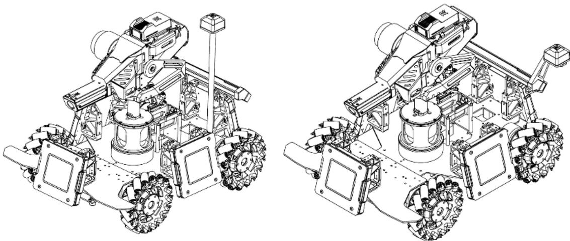
图 3-46 定位模块安装示意图
