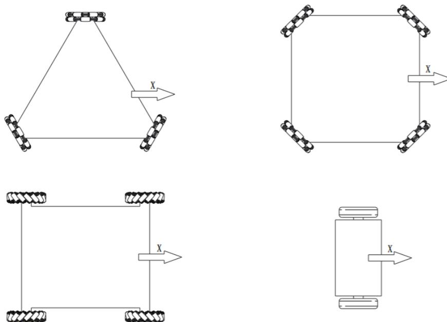
图 3-18 机器人不同底盘形态 X 轴示意图
