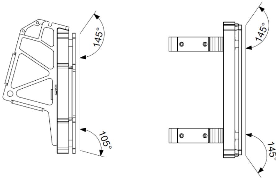
**S102** 工程机器人的所有装甲模块受攻击面下边缘 105°内不得被遮挡。所有的装甲模块下方的机器人外边缘与装甲模块下边缘的垂直距离小于 100mm。四块装甲模块中至少三块装甲模块满足上、左、右边缘 145°内不被遮挡，允许有至多一块装甲模块可以在受攻击面上、左、右边缘的 145°内发生有条件遮挡，遮挡条件为：在该装甲模块受攻击面所在的平面上，距离装甲模块的上边缘大于 150mm，或距离左、右边缘大于 170mm 可以发生遮挡，即下图阴影部分不可被遮挡。
