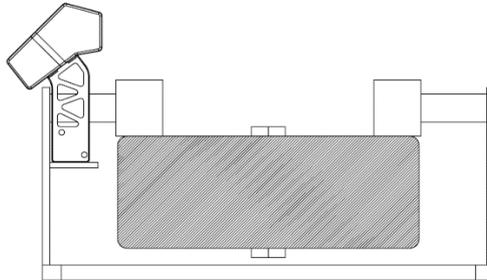
图 3-13 哨兵机器人灯条模块示意图
